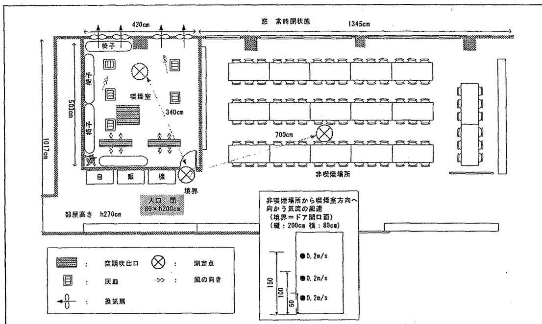
※図中に、測定点、各測定点に関する特記事項、窓の開閉状況を記し、排気装置による空気の流れを矢印で示すこと。空気清浄装置を使用している場合は、当該装置の排気の方角を矢印で示すこと。
